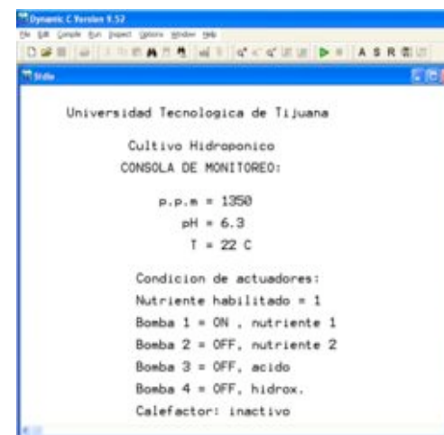
Figura 4. Consola de monitoreo hidropónico sólo para la vista del operador a distancia.
